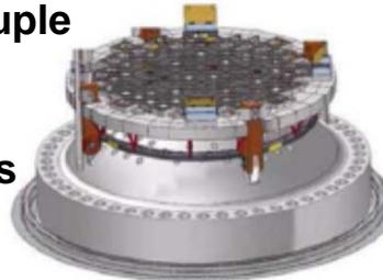
1. Déshabillage couvercle "A Remplacer" dans le Bâtiment Réacteur
