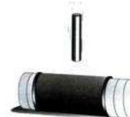
Pénétration d'une barre de 6 kg lâchée d'une hauteur de 1 m
